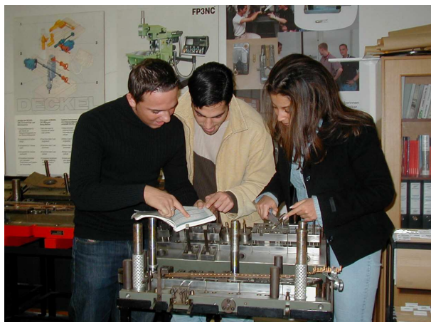
Abb.: Ein Folgeverbundwerkzeug wird analysiert.
